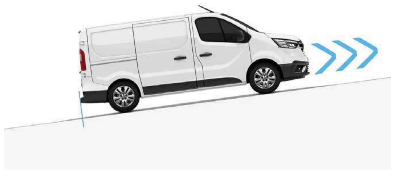
asistente de arranque en pendiente (HSA) Junto con el ESC, mantiene la presión de los frenos durante dos segundos para que tengas tiempo de acelerar. El sistema se activa al detectar una pendiente superior al 3%.
